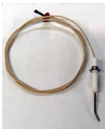
Sonda płomienia Długość sondy = całkowita 46,55 mm 32,95 mm do kąta 13,79 mm kąt do końcówki Odchylenie końcówki od 0° = 27°
