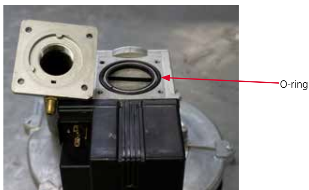
Zespół kołnierza wlotowego zaworu gazowego Photon 120
