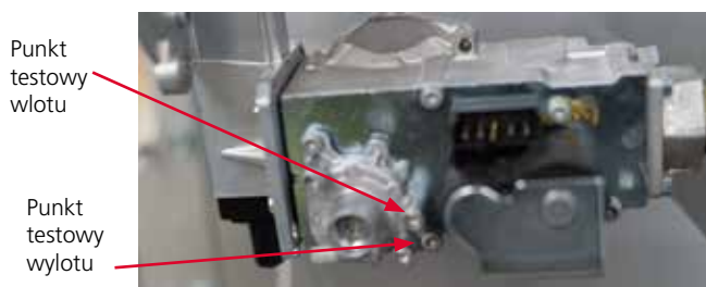
Punkty prób ciśnieniowych gazu dla Photon 100
