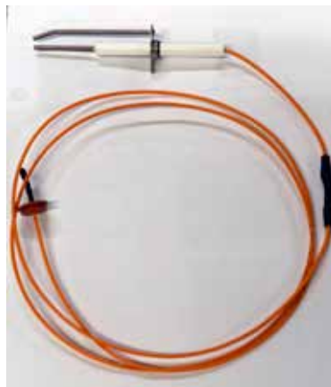
Sonda iskier Długość sondy = 78,5 mm długa sonda 42,3 mm krótka sonda 3,5±0,5 mm odstęp między sondami Kąt sondy = 20°
